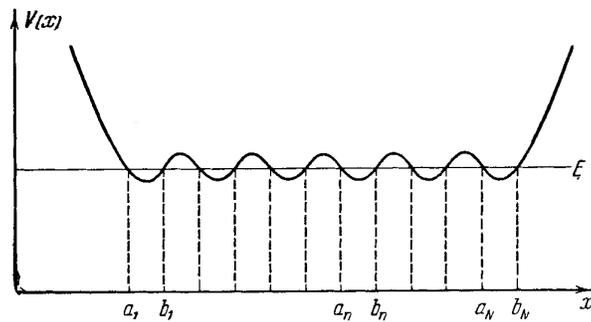
Рис. 1: Модель одномерного кристалла
